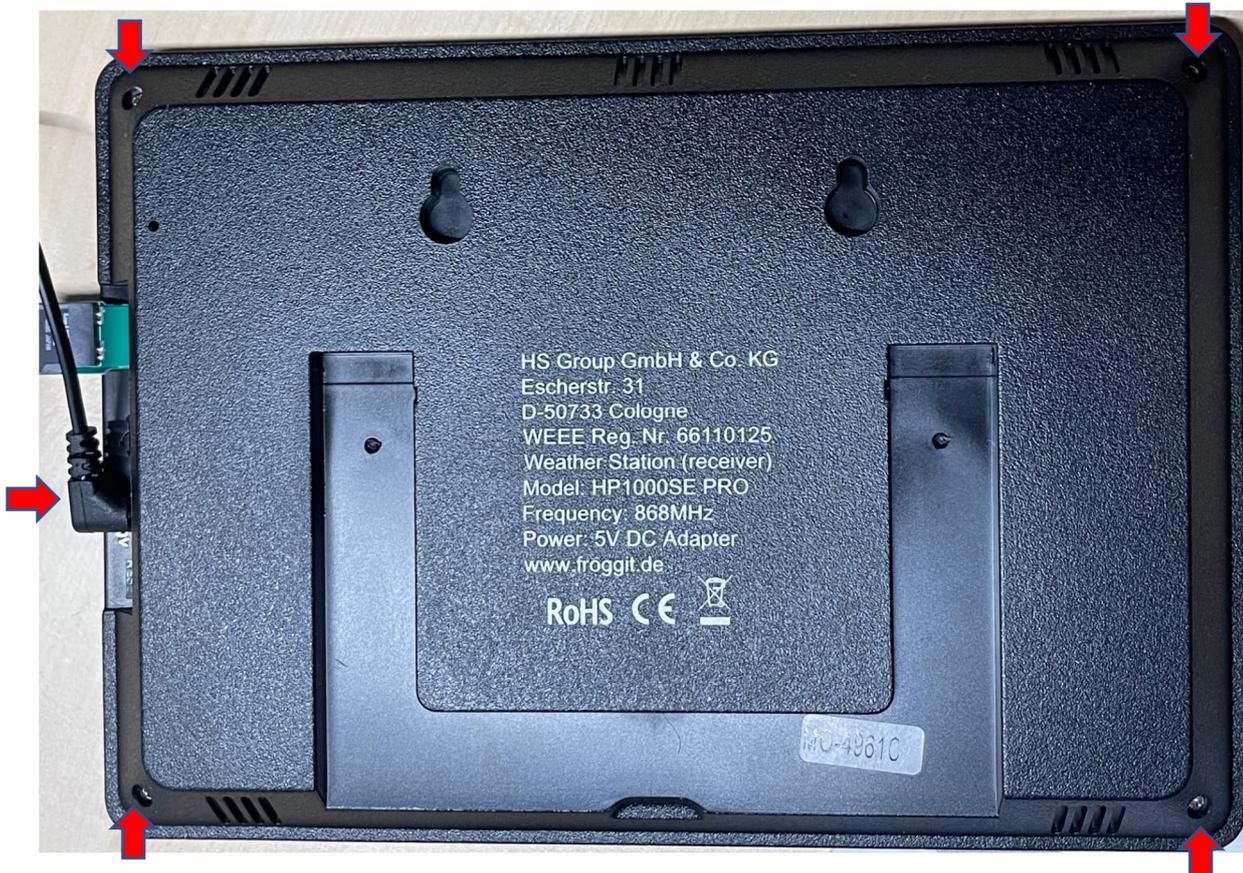
Das Gehäuse ist verclipst. Vorsichtig mit öffnen
